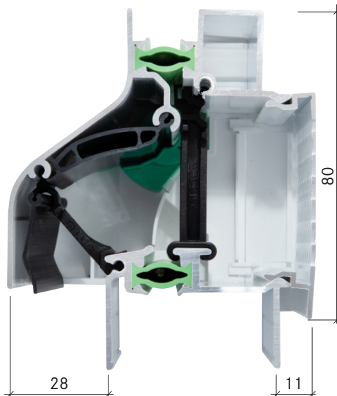
DucoKlep 15 'ZR' Voor glasdiktes: 40/44/48 mm
